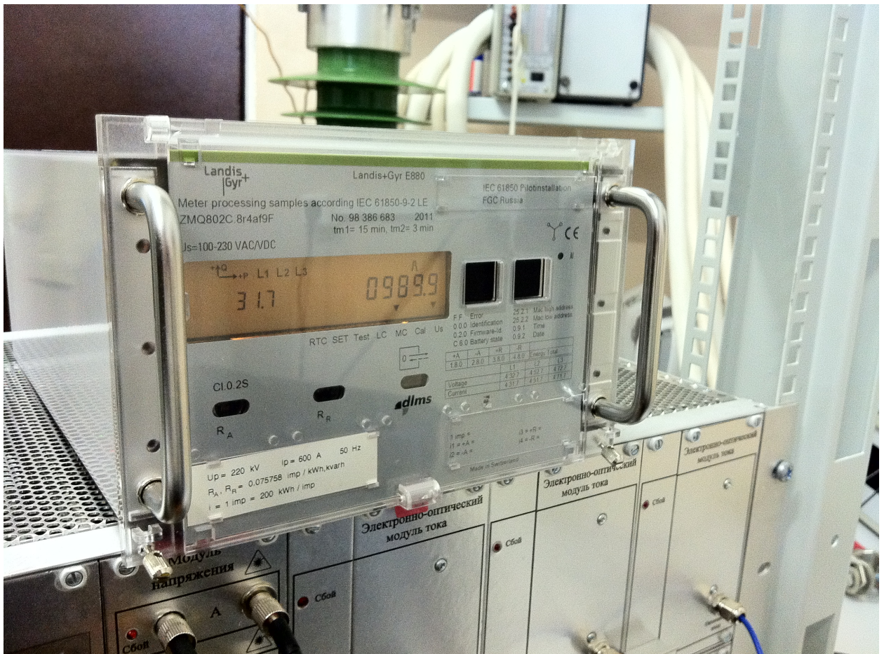
Рис. 3. Измерения тока, фиксируемые прибором учета электроэнергии ZMQ802C.
